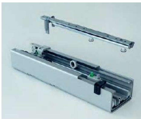
Guida ad estrazione totale per colonne vano 200-300-400-450-600 mm 100 kg di portata, ammortizzazione in apertura e in chiusura
