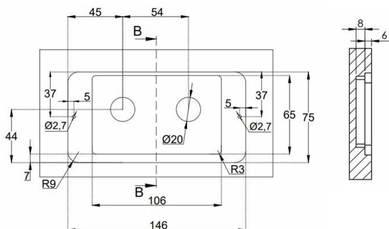
1. dimensione del foro necessario per alloggiare la schiuma con l'elettronica
